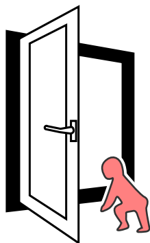
Kui väikelastel või vaimupuudega isikutel on vaba juurdepääs aknale, tuleb akna avamist takistada, kasutades avanemispiirajat või lukustatavat käepidet.
